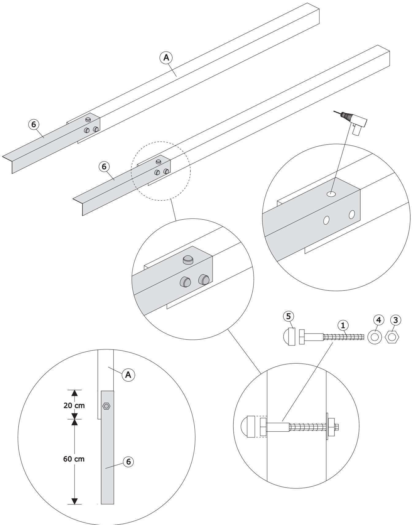
Befestigen Sie die Bodenanker an den Pfosten. Löcher vorbohren.
